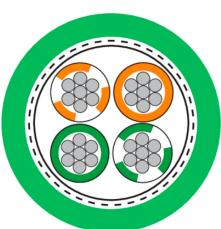
LAPP KABEL STUTIGART ETHERLINE® P EC FLEX Cat.5e
